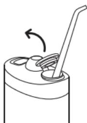
Насадку можно хранить в специальном отделении внутри корпуса: откройте клапан, расположенный рядом с гнездом насадки, и поместите насадку внутрь наконечником вверх. Закройте клапан.
